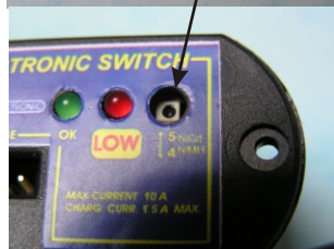
Přepínání počtu článků pro indikaci napětí.
